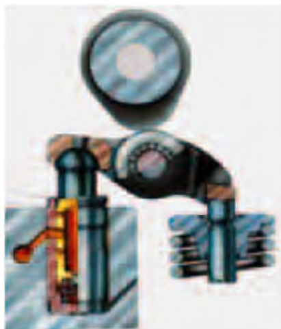
Rys. 2 Układ regulacji luzów z osadzoną na wałku, dwustronną dźwignią zaworową (Ford Sierra 2,3 V6) przez samochód nawet 100 km.
