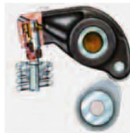
Rys. 2 Układ regulacji luzów z osadzoną na wałku, dwustronną dźwignią zaworową (Ford Sierra 2,3 V6) przez samochód nawet 100 km.
