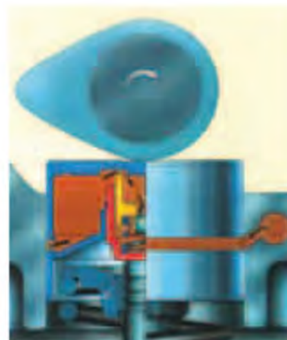
Rys. 3 Układ regulacji luzów o bezpośrednim działaniu (VW Golf 2, 1.6D)
